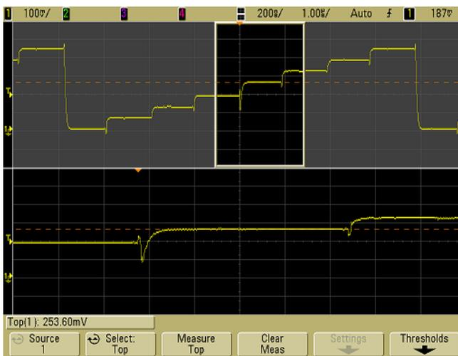
图 34 隔离顶部测量区域
