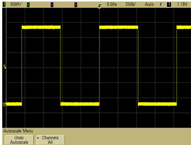
如果您看到波形，但方波形状不正确，与上面所示有所不同，请执行步骤第 37 页上的“[补偿示波器探头](#)”。
